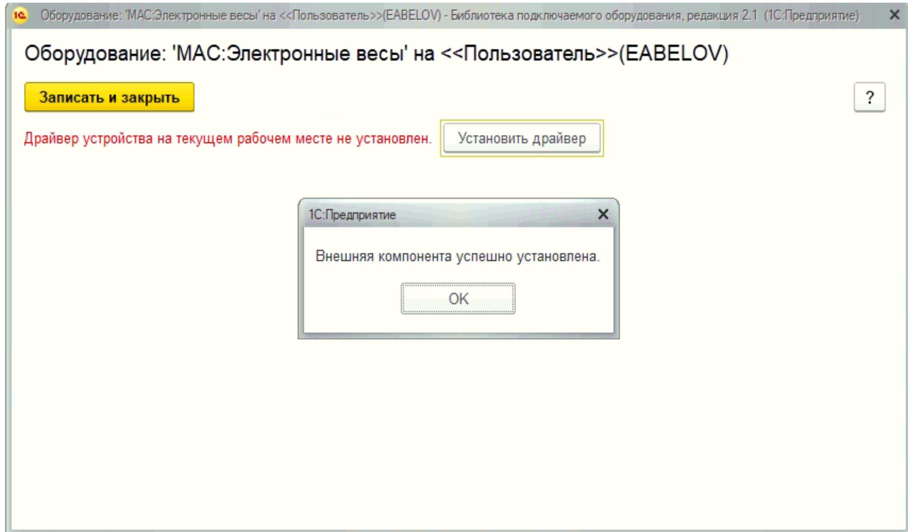
Шаг 6. После нажатия на кнопку ОК станут доступны описание драйвера и параметры подключения. В параметрах подключения необходимо выбрать COM-порт, к которому подключены весы.
